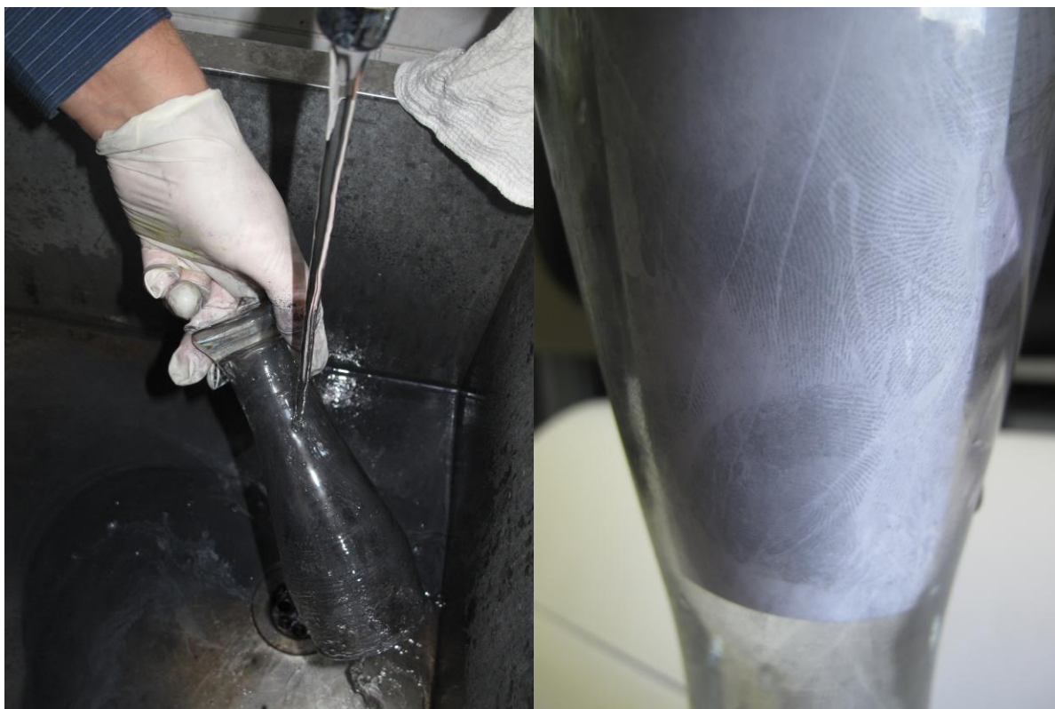
Фото. Смыв SPR (слева), выявленные следы (справа).
