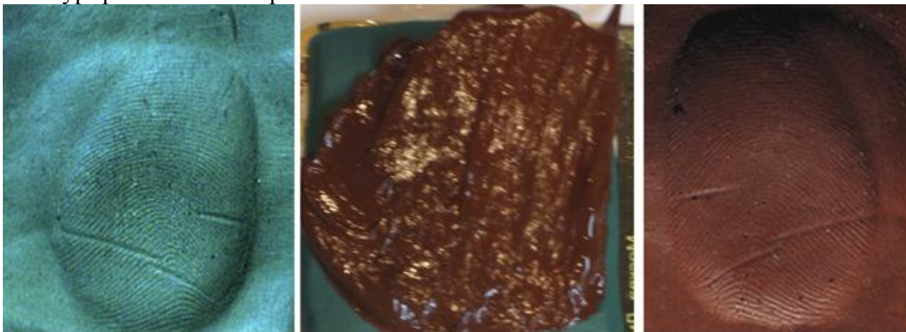
Фото. Экспериментальный след, нанесенный компаунд, полученный оттиск следа.
