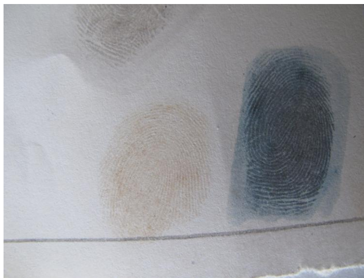
Фото. След выявленные парами йода (слева), след обработан фиксативом йода(справа).
